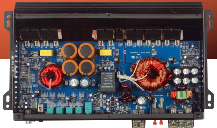
Der kräftige Netztrafo ist für über 800 Watt gut. Alle Leistungshalbleiter sitzen am hinteren Kühlkörper
