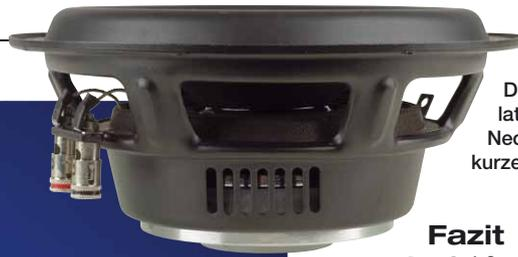
Der kleine Subwoofer baut relativ flach, und das ohne teures Neodym, Der Ferritring wurde kurzerhand in den Korb verlegt
